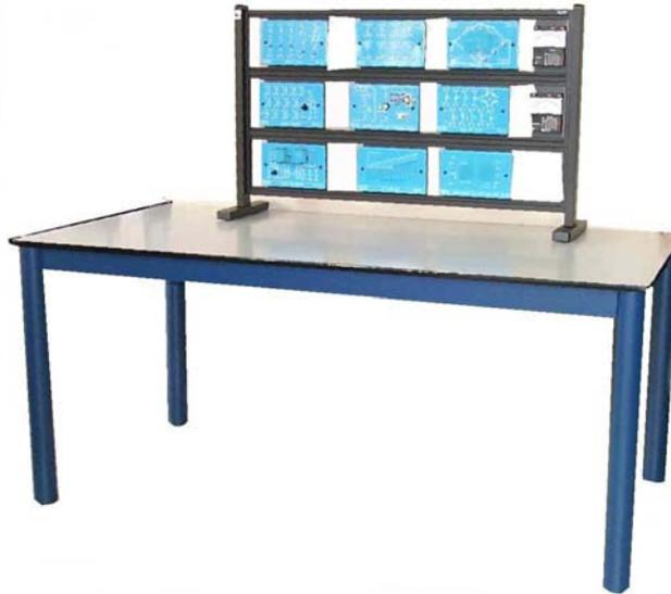
Ce banc est caractérisé pour son caractère exhaustif et pour l'efficacité de sa dotation permettant de réaliser une grande gamme d'exercices dans le domaine de l'électronique de puissance avec une particulière attention aux trois méthodes de redressement principales monophasées et triphasées avec des ponts **non contrôlés**, **semi-contrôlés** et **totalemt contrôlés**.
