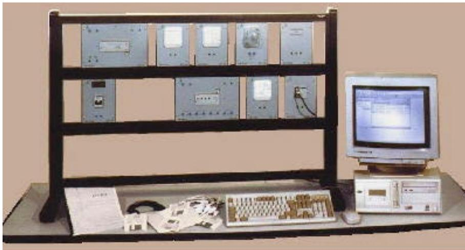
L'ensemble se compose d'une série de panneaux comme on a listé ci-dessous, réalisés en matériel isolé avec une sérigraphie avec la numération réelle des bornes de chaque composant électrique monté.
